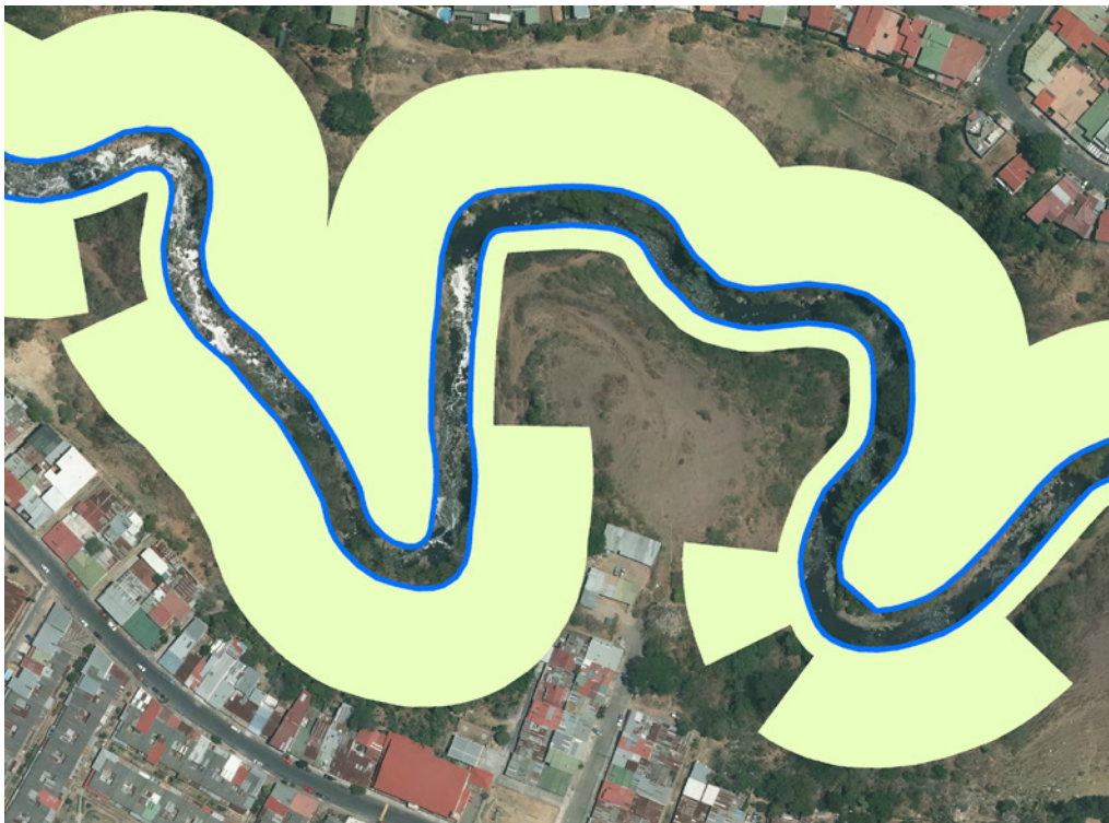
Imagen 12: Área de protección de 10 metros o 50 metros, según la pendiente del terreno.
