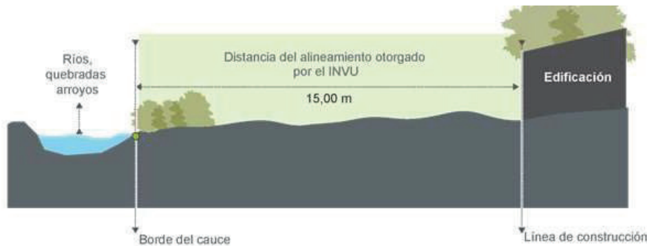
Figura 5. Diagrama de alineamiento en ríos quebradas y arroyos con pendientes < 40% en zona rural
