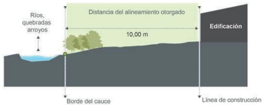
Figura 4. Diagrama de alineamiento en ríos quebradas y arroyos con pendientes < 40% en zona urbana
